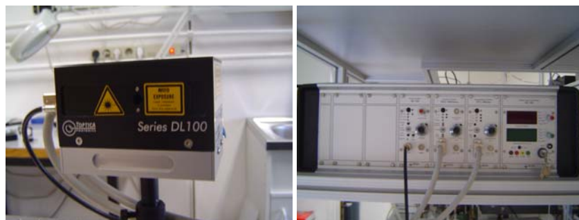
Slika 4. 19 Laserska dioda u konfiguraciji s vanjskom rešetkom Toptica Photonics Diode Laser Head DL 100 i
