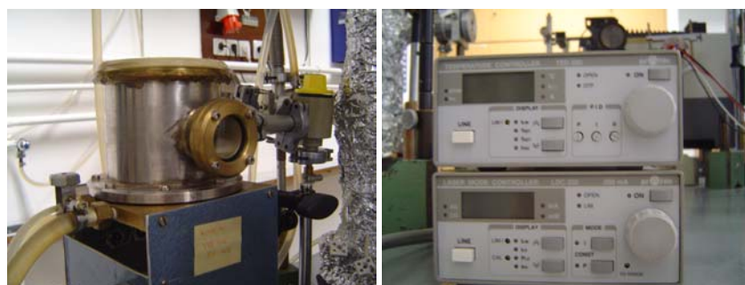
Slika 4. 20 Oklop s laserskim diodama Thorlabs COL806/30 i Thorlabs HL7851G i pripadni strujno-temperaturni kontroler
