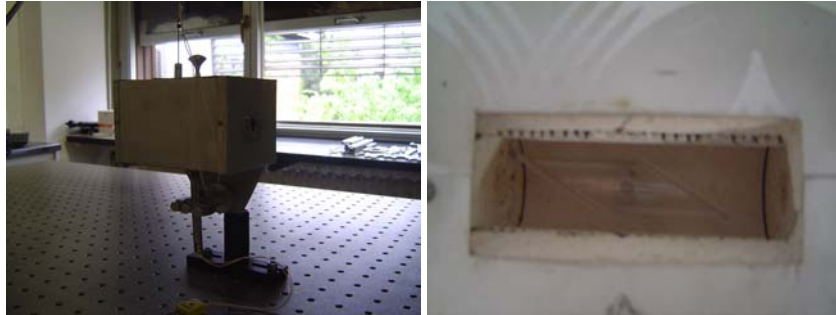
Slika 4. 4 Specijalno konstruirana peć i smještaj safirne kivete u peći
