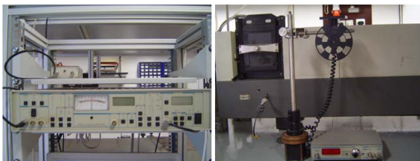
Slika 4. 10 Usko pojasno pojačalo Stanford Research Systems SR510 i s njim povezan prekidač svjetla Stanford Research Systems SR540 Chopper
