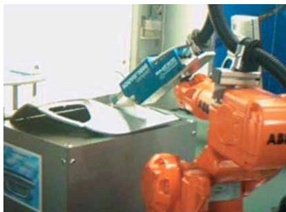
Slika 4. Robot s laserskom glavom kakav se koristi u automobilske industriji. Snimljeno na Laserskom velesajmu u Münchenu 2005. godine.
