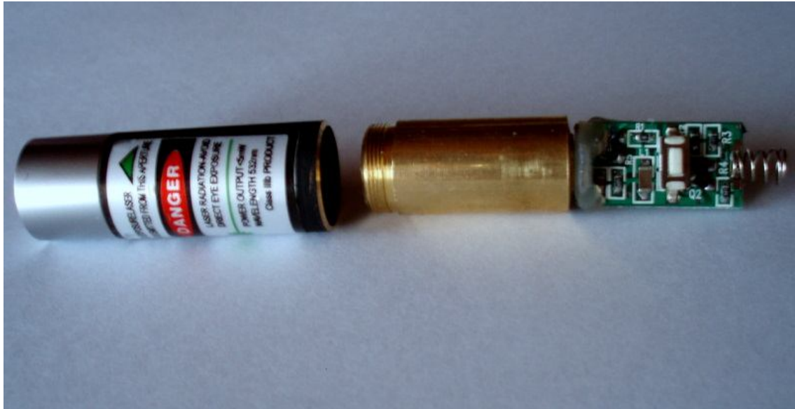
Slika 3-1 Skidanje dijela koji omata laser
