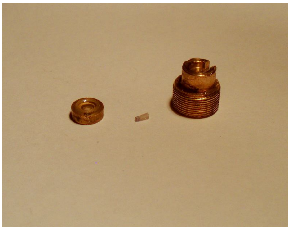
Slika 3-7 Dio s kristalom u unutrašnjosti i filter
